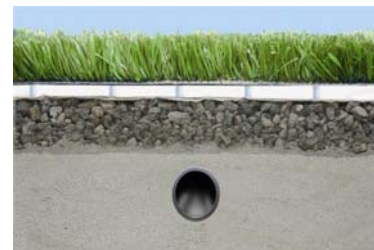
Der Alveo Sports Layer (in der Grafik weiß) bildet die elastische Tragschicht des Belagsystems zwischen Fundament und Kunstrasenfaser.
