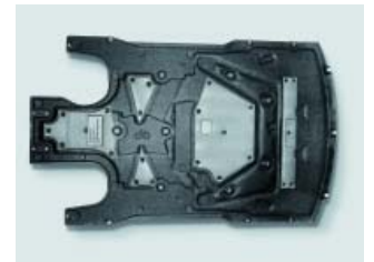
Der Flachabsorber von Röchling Automotive mit dem mikroperforierten Polyolefin-Schaumstoff Alveocel von Sekisui Alveo (grau) deckt im Sportwagen effizient ein sehr breites Frequenzspektrum ab.
